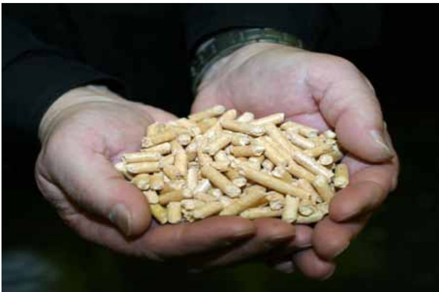
Kaksi litraa puupellettejä vastaa energiamäärältään yhtä litraa öljyä. Kuva: Suomen Pellettienergiayhdistys ry.
