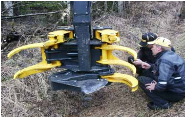
Niin sanottu giljotiinikoura kerää kaadon yhteydessä energiapuuta. Koura on helppo vaihtaa hakkuukoneeseen. Energiapuun korjuuseen on jo olemassa osaavat yrittäjät ja kalusto.
