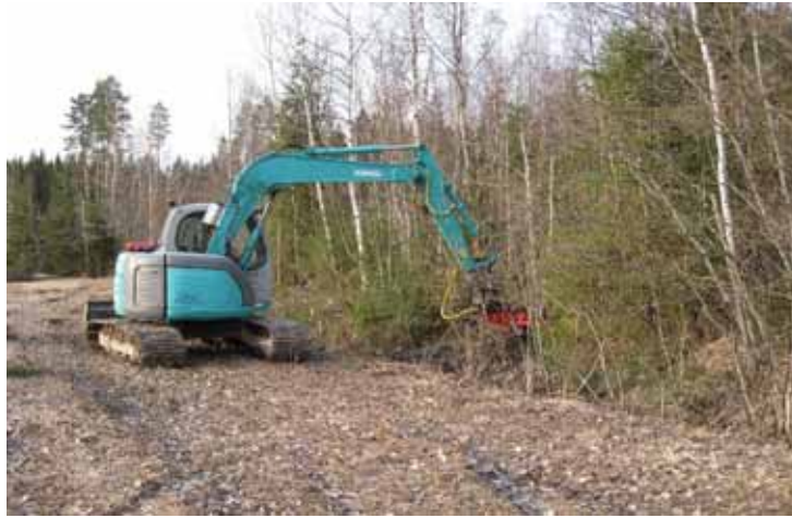
Pellon reunojen raivausta. Tässä työ tehdään kaivurilla, jossa on energiapuuta keräävä koura.
